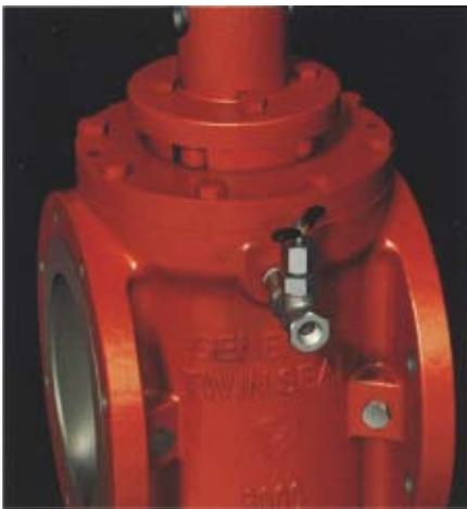
Dieses TWIN SEAL-Ventil verfügt über ein manuelles Entlüftungsventil. Dieses im Gehäuseinneren integrierte Entlüftungsventil wird erst nach dem Schließen des TWIN SEAL-Ventils *geöffnet*. Die Wirksamkeit der Dichtung kann sofort festgestellt werden. Dieses Entlüftungsventil muss *geschlossen* werden, bevor das TWIN SEAL-Ventil *wieder geöffnet* wird.
