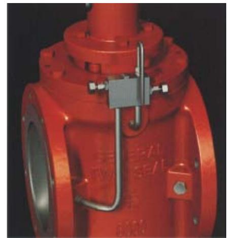
Der Sicherheitsblock / die DTR arbeitet genauso wie die Standard-Sicherheitsentlüftung. Alle Funktionskomponenten befinden sich jedoch in einem so gut wie unzerstörbaren, kompakten Kohlenstoffstahl-Sammelrohr. Die Vorteile dieser Vorfalls-Steuerungsausrüstung sind: Brandsicherheit, voller Zugriff auf Komponenten zu Wartungszwecken, alle Muffen geschweißt, schweres Wandrohr und Vorfallssteuerung.
